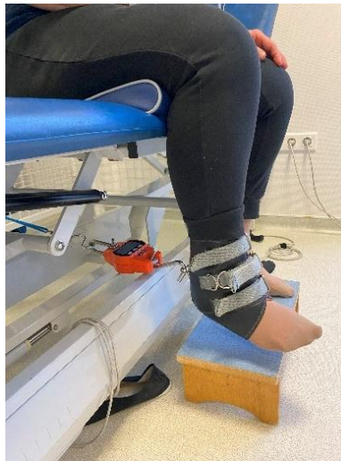
Figure 5 : installation pour la mesure de force du quadriceps.
